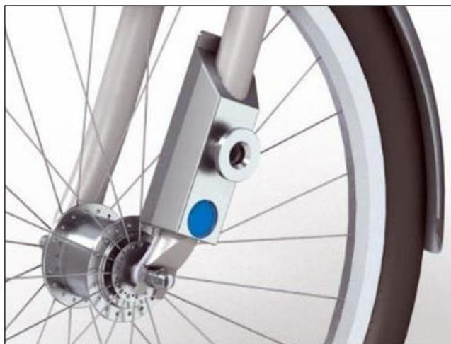
Smart-TEC社製RFIDタグがそれぞれの自転車のフロントフォークの金属製ドッキングアダプターの掘り込み部分に装着されている。
