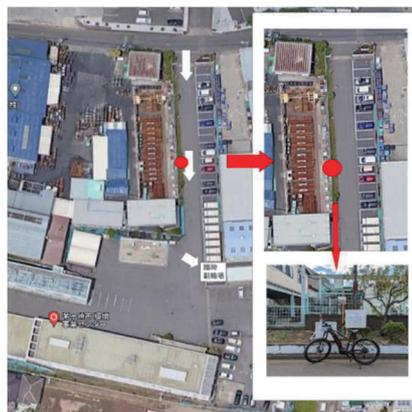
出勤時と退勤時にアンテナ装置前を通過することで、自転車に取付けたICタグ情報（ID）を取得する。
