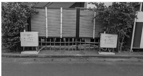
2台のアンテナは自転車通過に対して、左右の位置にアンテナを配置し1・2点間の通過の遅延による進行方向の判断基準となる位置関係にあり、この2点でのダイバシティ化をした場合の読取精度の比較検討とした。
