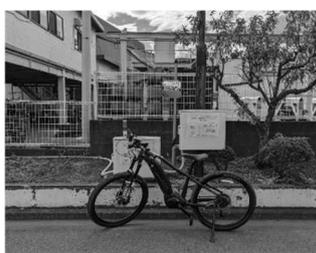
2台のアンテナを1本のポールに、上下に位置をずらして設置した。アンテナとタグの位置関係は先述した通り対面位置が望ましいが、上下に配置することでの高さの影響の検討材料として、泥除けの貼付位置より高くした場合の読取精度の検証を試みた設計である。通過条件は、前社と異なり自転車に乗ったまま走行可能であり、また、特に速度制限は設定していない。
